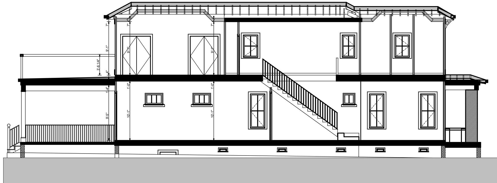
1 SECTION - STAIR SCALE: 1/8" = 1'-0"
